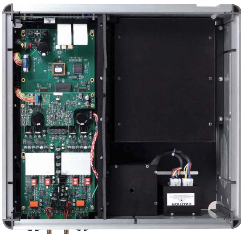
Wyraźny podział na sekcje: po jednej stronie napęd pod ciężkim ekranem oraz zasilacz, po drugiej - część dekodująca.
