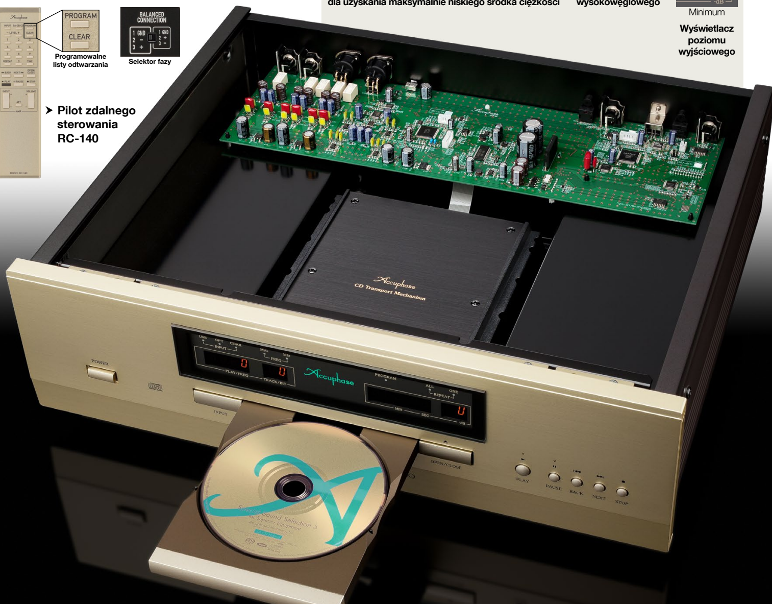
Płyta dolna z zagłębionym gniazdem na napęd CD dla uzyskania maksymalnie niskiego środka ciężkości
